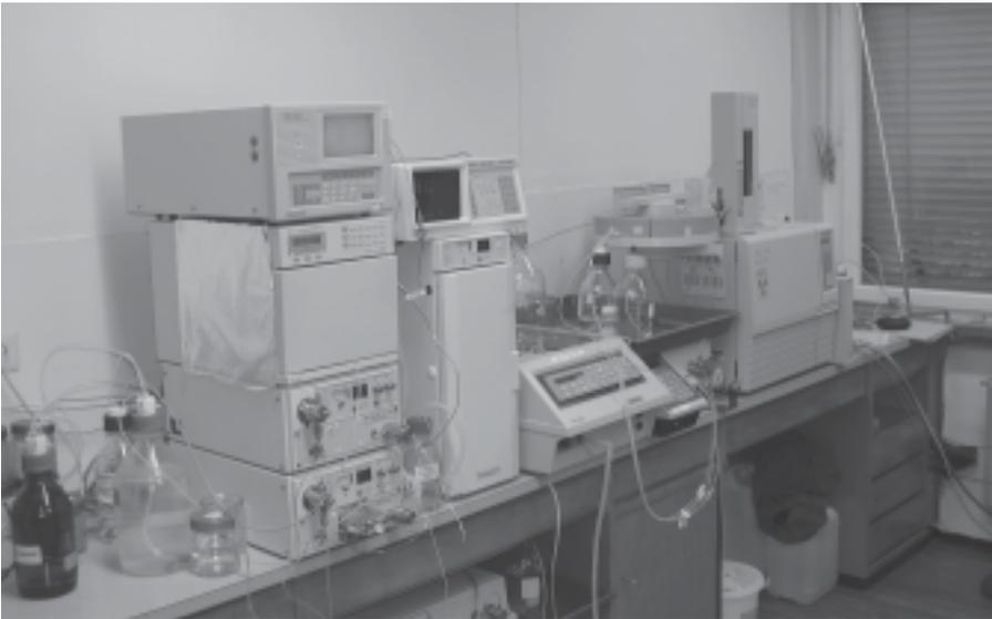
*Die technischen Standards verändern sich: Ein Labor ausgestattet mit HPLC und Gaschromatographen für die Spurenanalytik.*
